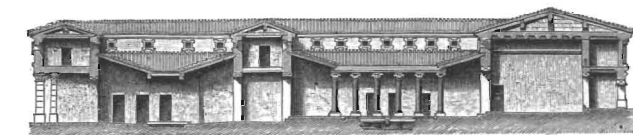
Vestibulum Ostium Atrium Tablinum Peristylum Oecus Рис. 5. Домъ Пансы. Разрѣзъ по А—В.
